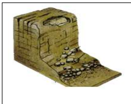
Fuente: Turner y Schuster, 1996 Fig. 7. Derrumbes o caídas.
